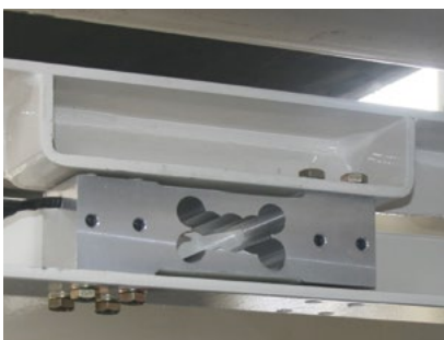
Sistema de pesagem individual com célula de carga centralizada
