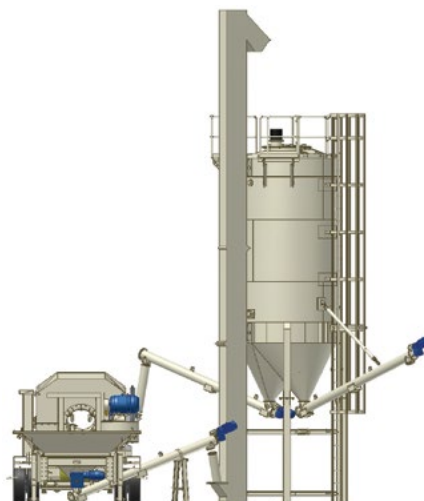
Sistema de coleta de finos com silo de 20 m 3
