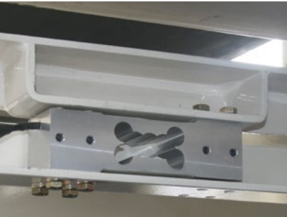
Sistema de pesagem individual com célula de carga centralizada
