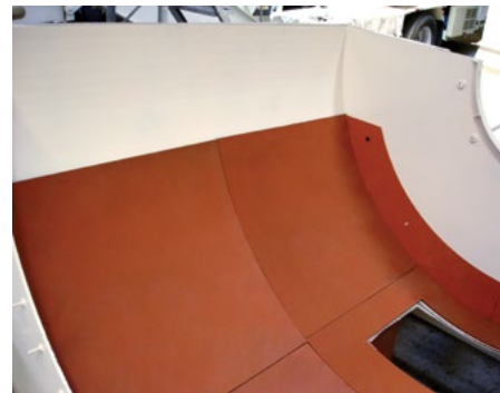
Revestimento do misturador
